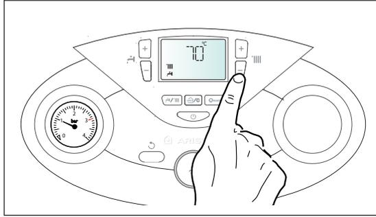
**Регулирование температуры воды в контуре ГВС****CLAS EVO**
