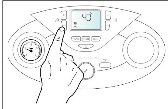
**Регулирование температуры воды в контуре ГВС****CLAS EVO SYSTEM**
